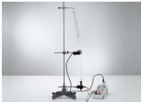
Au cours de l'expérience P1.5.2.1, on trace en fonction du temps les oscillations harmoniques d'un pendule à ressort avec le capteur pour le transducteur de mouvement et le système d'acquisition CASSY. Pour l'exploitation, on compare sur l'écran les grandeurs oscillantes distance x, vitesse v et accélération a entre elles.
