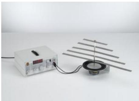
Dans l'expérience P1.6.1.3, on excite le modèle de ressort à lame avec différentes fréquences  $f$  afin d'en étudier la résonance.
