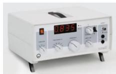
Générateur de signaux sinusoïdaux, triangulaires et carrés, avec amplificateur de puissance intégré : 5W (sinus), 10W (carré), fréquences de 0,1Hz à 100kHz, affichage numérique de la fréquence.
