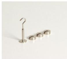
Comprend 1 plateau support et 3 masses fendues pour entraîner le chariot de mesure ( 33700 ) et obtenir une masse totale de 100 g.
