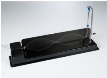
Au cours de l'expérience P1.6.3.1, on détermine, pour une fréquence d'excitation fixée, les longueurs d'onde en des ondes stationnaires pour différentes longueurs de corde  $s$  et différentes masses de corde  $m$ .
