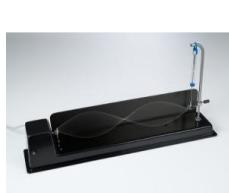
Au cours de l' expérience P1.6.3.1, on détermine, pour une fréquence d'excitation fixée, les longueurs d'onde pour des ondes stationnaires pour différentes longueurs de corde  $s$  et différentes masses de corde  $m$ .
