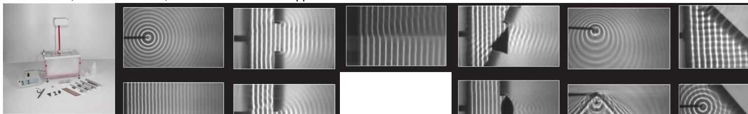
Pour illustrer la propagation des ondes, la réflexion, la diffraction, les interférences, la réfraction et l'effet Doppler sur l'exemple des ondes à la surface de l'eau.
