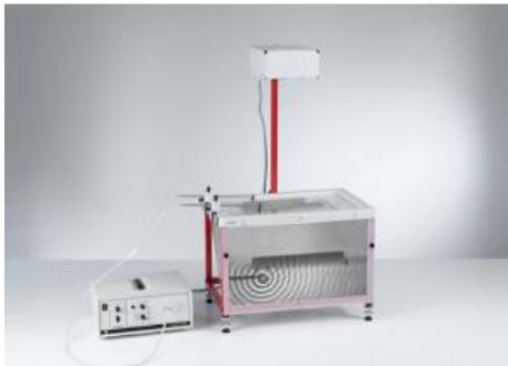
Au cours de l'expérience P1.6.5.2, on refait l'expérience de Lloyd sur la formation d'une interférence à deux faisceaux d'ondes à la surface de l'eau.
