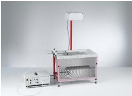
Au cours de l'expérience P1.6.5.2, on refait l'expérience de Lloyd sur la formation d'une interférence à deux faisceaux d'ondes à la surface de l'eau.
