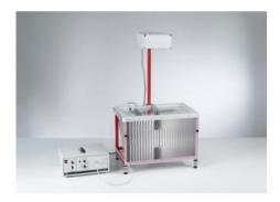
P1.6.5.3 Diffraction par une fente et un obstacle d'ondes
