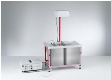
L'expérience P1.6.5.5 montre la formation d'ondes stationnaires par réflexion d'ondes à la surface de l'eau sur une paroi parallèle à l'excitateur d'ondes.
