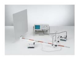
On utilise au cours de l'expérience P1.7.4.2 le principe de l'écho-sonde pour déterminer la vitesse du son dans l'air et également pour déterminer des distances.
