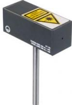
Source lumineuse monochromatique compacte, spécialement conçue pour des expériences sur l'interférence et la diffraction.
