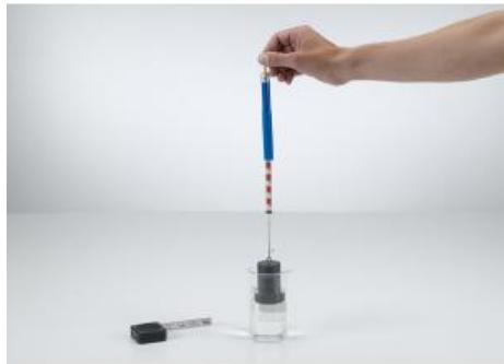
Durant l'expérience P1.8.2.2, un cylindre plein est immergé dans différents liquides, à une profondeur h. Le poids
