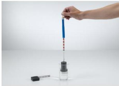
Durant l'expérience P1.8.2.2, un cylindre plein est immergé dans différents liquides, à une profondeur  $h$ .
