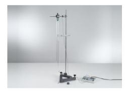
P1.8.3.1 Construction d'un viscosimètre à chute de bille
