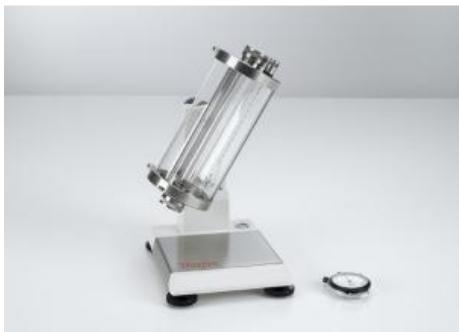
Durant l'expérience P1.8.3.2 , on étudie à température ambiante quelle est l'influence de la concentration d'une solution sur sa viscosité sur l'exemple de solutions de sucre concentrées.
