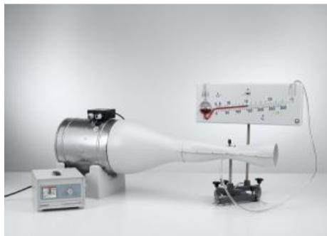
Pour vérifier les deux équations, on mesure au cours d'expérience P1.8.5.1 la pression statique dans un tube Venturi à des sections différentes.
