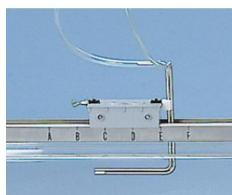
Pour mesurer la pression statique, la pression totale et la pression dynamique d'un gaz en écoulement.
