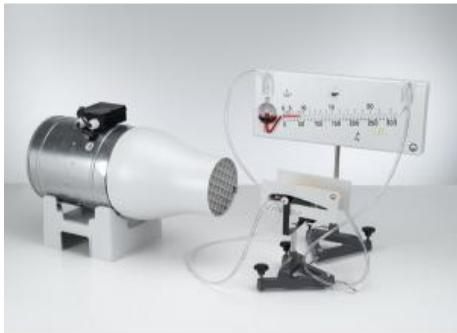
L'objet des expériences P1.8.6.3 et P1.8.6.6 est la mesure de la pression statique  $p$  à plusieurs points de la face supérieure et de la face inférieure d'un profil d'aile.
