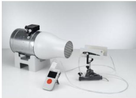
L'objet des expériences P1.8.6.3 et P1.8.6.6 est la mesure de la pression statique  $p$  en plusieurs points de la face supérieure et de la face inférieure d'un profil d'aile.
