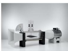
Au cours de l' expérience P1.8.7.1, on mesure la traînée aérodynamique FW et la poussée verticale FA d'une surface portante en fonction de l'angle d'attaque  $\alpha$  de l'aile par rapport à la direction du courant.
