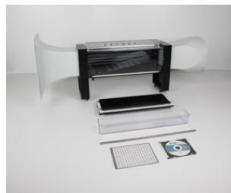
Veine d'essais fermée à parois latérales transparentes et plaque de fond interchangeable pour des expériences quantitatives en aérodynamique et en physique du vol avec le ventilateur aspirant/refoulant ( 37304 ).
