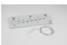
Manomètre à tube incliné pour mesurer les dépressions, les surpressions et les pressions différentielles d'un gaz en écoulement avec la sonde manométrique ( 373 13 ).
