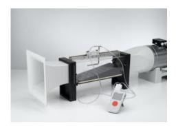
P1.8.7.4 Vérification de l'équation de Bernoulli -Mesure avec un capteur de pression et le CASSY
