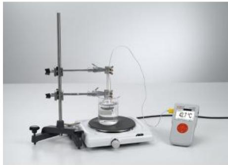
Au cours de l'expérience P2.1.2.2, on détermine le coefficient de dilatation cubique de l'eau et de l'éthanol à l'aide d'un dilatomètre volumétrique en verre.
