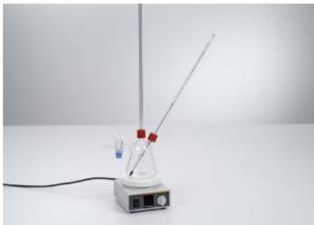
Au cours de l'expérience P2.1.3.1, on met en évidence la masse volumique maximale de l'eau en mesurant la dilatation dans un récipient avec capillaire.
