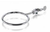
Sert de support aux toiles calorifuges et aux récipients posés dessus, inoxydable.
