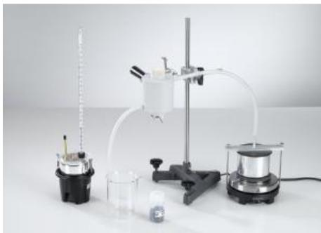
Pour déterminer la capacité thermique spécifique, on pèse au cours de l'expérience P2.3.2.1 différentes matières sous forme de grenade, on les chauffe à la température 1 avec de la vapeur d'eau puis on les jette dans une quantité d'eau pesée de température 2.
