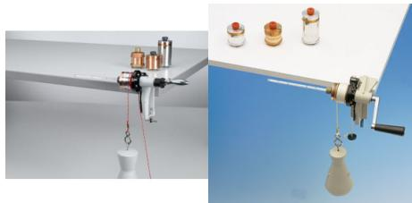
Dans l'expérience P2.3.3.1, on met en évidence l'équivalence entre énergie mécanique et énergie thermique: à l'aide d'une manivelle, on fait tourner différents récipients calorimétriques sur leurs axes, les faisant ainsi chauffer par frottement contre une corde en nylon.
