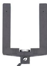
Barrière lumineuse de précision avec source à infrarouges pour la commande d'appareils de comptage et de mesure du temps pour l'expérimentation avec des corps en mouvement, par ex. pour l'étude du mouvement sur le rail, de la chute libre, des oscillations d'un pendule, de ressorts à lame ou de cordes.
