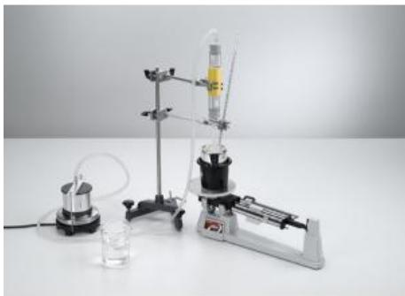
Durant l'expérience P2.4.1.1, pour déterminer la chaleur massique QV dévaporation de l'eau, on fait passer de la vapeur d'eau pure dans un calorimètre, faisant ainsi chauffer de l'eau froide à la température de mélange m. La vapeur d'eau se condense en eau du fait de la chaleur dévaporation cédée.
