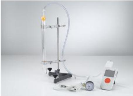
Durant l'expérience P2.5.2.1, la colonne d'air reste à température ambiante constante T. Elle a pour une pression extérieure  $p_0$  un volume  $V_0$  fermé par la bulle de mercure.
