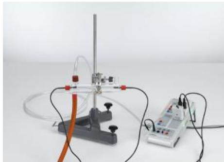
Dans l'expérience P2.5.4.1, le flux de gaz acheminé est rétracté et dilaté par une membrane. L'augmentation du volume occupé par le gaz derrière l'obstacle fait en sorte que l'écartement des particules moyen augmente, ceci entraînant une variation de la température du gaz. On détermine la pression et la différence de température en amont et en aval de la membrane.
