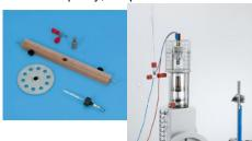
Pour la détermination quantitative du bilan des puissances, du freinage mécanique, de la mesure sans contact de la vitesse de rotation, de mesure du débit et de la température du flux d'eau de refroidissement ainsi que pour la compensation électrique de la puissance frigori À utiliser avec le moteur à air chaud, 388 182. de la puissance frigorifique.
