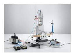
P2.6.2.2 Détermination du rendement du moteur à air
