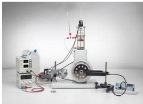
Dans l'expérience P2.6.2.3, on détermine le rendement
