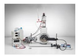
P2.6.2.3 Détermination du rendement du moteur à air chaud comme machine frigorifique
