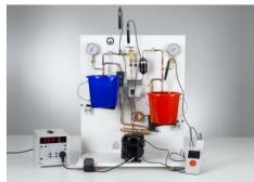
Dans l'expérience P2.6.3.3, on suit les transformations dénergie dans la pompe à chaleur grâce à un diagramme de Mollier, dans lequel la pression  $p$  est portée en fonction de lenthalpie spécifique  $h$  de lagent réfrigérant. Les enthalpies correspondantes  $h_a$ ,  $h_b$ ,  $h_e$  et  $h_f$  sont déterminées aussi bien daprès les pressions  $p_1$  et  $p_2$  dans l'évaporateur et le liquéfacteur que daprès les températures  $T_a$ ,  $T_b$ ,  $T_e$  et  $T_f$  du réfrigérant.
