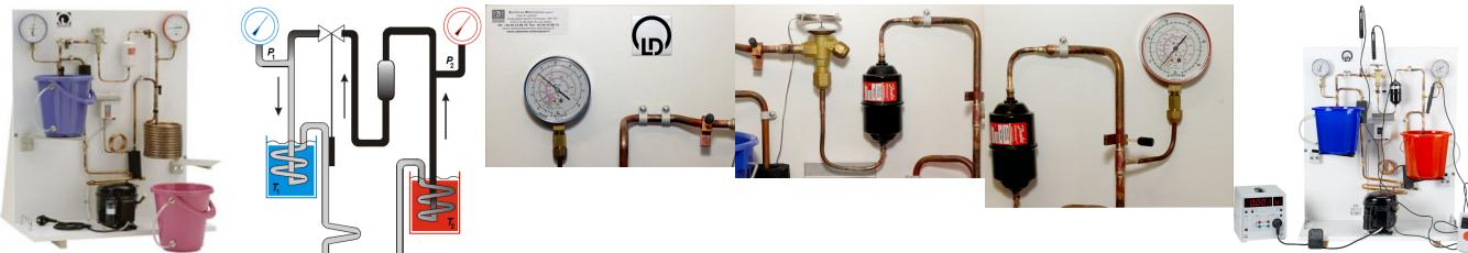
Modèle didactique d'une pompe à chaleur avec compresseur monté sur un panneau de démonstration, avec un manomètre à aiguille dans la partie basse pression et un autre dans la partie haute pression.
