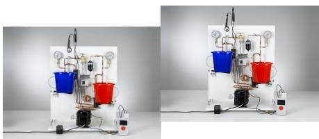
Au cours de l'expérience P2.6.3.2, on trace les températures Tf et Th aux sorties de la vanne de détente et de l'évaporateur.
