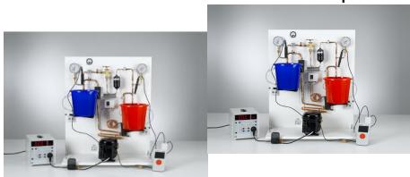
L'objet de l'expérience P2.6.3.1 est de déterminer le coefficient d'efficacité
