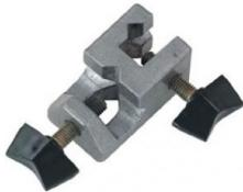
Pour attacher solidement et assembler des tiges et des tubes ainsi que pour fixer des plaques, ou encore servir de cavalier pour le petit banc optique ( 460 43 ).
