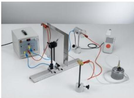
Dans l'expérience P3.1.3.3 on détermine le potentiel dans le condensateur à plateaux.
