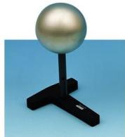
Pour expériences d'électrostatique, par exemple pour la détermination de la capacité d'une sphère à partir de la charge et de la tension, pour le montage d'un condensateur sphérique avec la paire d'hémisphères ( 54305 ) ou pour la détermination du potentiel tout autour d'une sphère électrisée. Sur tige isolante, avec douille de raccordement de 4 mm. Utilisation possible aussi bien sur la table, avec le pied, que sur le banc d'optique.
