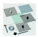
Plaques de condensateur, sonde à flamme et accessoires pour montages expérimentaux avec le mesureur de champ électrique S (524 080) dans le domaine de l'électrostatique.
