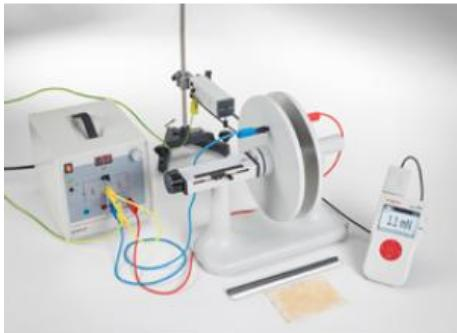
L'expérience P3.1.4.4 consiste à amener une charge  $Q$  la plus grande possible sur une cuillère électrostatique plate au moyen d'une tige en plastique frottée.
