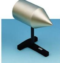
Pour expériences d'électrostatique, par exemple pour illustrer l'effet de pointe sur les corps électrisés. Sur pied isolant.
