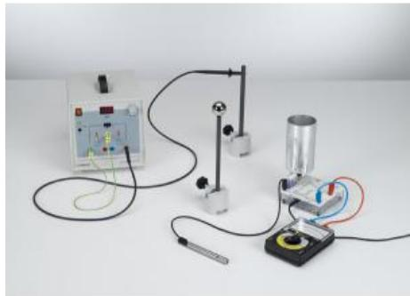
L'expérience P3.1.6.1 consiste à déterminer la capacité d'une sphère dans un espace libre, en électrisant la sphère avec une haute tension  $U$  connue et en mesurant sa charge  $Q$  avec un amplificateur électromètre branché en coulombmètre.
