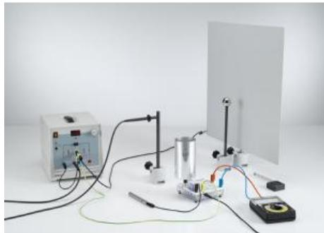
L'expérience P3.1.6.2 montre que la capacité d'un corps dépend aussi de son environnement, par exemple de la distance à d'autres conducteurs reliés à la terre.
