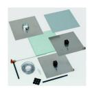
Plaques de condensateur, sonde à flamme et accessoires pour montages expérimentaux avec le mesureur de champ électrique S (524 080) dans le domaine de l'électrostatique.
