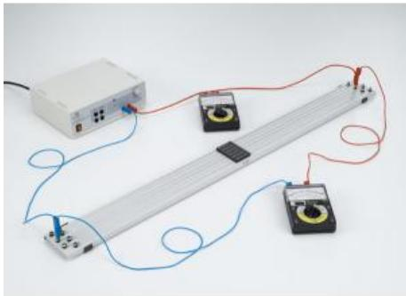
L'expérience P3.2.2.1 consiste à vérifier la proportionnalité entre le courant et la tension pour des fils métalliques de matériau différent, ainsi que dépaisseur et de longueur différentes et à déterminer la résistance spécifique du matériau utilisé.
