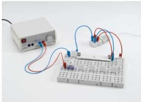
L'expérience P3.2.2.2 consiste à vérifier la proportionnalité entre le courant et la tension sur un fil métallique.
