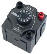
Résistance de mesure en montage potentiométrique, réglable par commutateur rotatif ; possibilité d'assemblage d'un jeu de décades à plusieurs niveaux en association avec d'autres décades de résistances.
