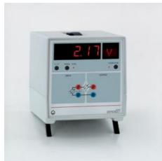
Pour la mesure et l'affichage de la tension efficace  $U$  et du courant efficace  $I$  pour des tensions et courants d'allure quelconque, de la puissance active  $P$  ainsi que de l'intégrale temporelle de  $P(t)$  (travail),  $U(t)$  (pointe de tension) et  $I(t)$  (charge). La gamme de puissance s'étend sur 12 décades (de nW à kW).
