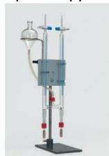
Voltamètre d'Hofmann, pour l'électrolyse de l'eau.
