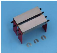
Sert à générer des champs magnétiques homogènes à l'aide du noyau en U ( 56211 ) et d'une ou de deux bobines.
