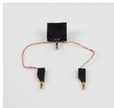
Le support de boucle permet de relier le capteur de forces (524060) et les boucles conductrices (51634).
