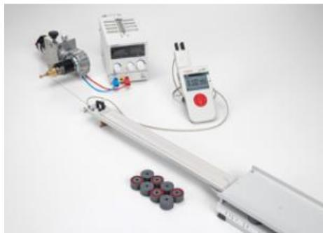
Dans l'expérience P3.4.2.1, un mobile est déplacé entre les pièces polaires d'un aimant comportant des boucles d'induction de largeur différente.
