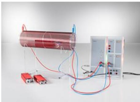
**P3.4.3.2 Mesure de la force électromotrice induite dans une boucle conductrice**
