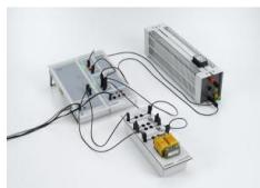
L'expérience P3.4.5.3 consiste à représenter la tension primaire et la tension secondaire de même que le courant primaire et le courant secondaire dun transformateur en charge.
