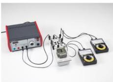
L'objet de l'expérience P3.4.5.1 est de mesurer la conversion de la tension du transformateur à vide et la conversion du courant du transformateur en court-circuit.
